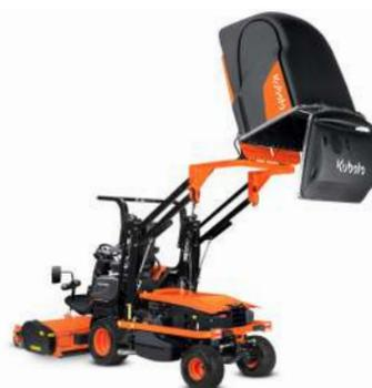
Aushubhöhe liegt bei 2,3 m. Mit dem hydraulisch betätigten Parallelogrammsystem und der großen Kipphöhe entladen Sie den Behälter auf effektive und sichere Weise.
